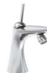
3.4155.1.004.111.1 Bidet single-lever mixer, with joystick cartridge, fixed spout and pop-up waste, spout reach 105 mm Bidetmischer, mit Joystick-Patrone, festem Auslauf und Ablaufventil, Ausladung 105 mm Mitigeur de bidet, avec cartouche joystick, goulot fixe et vidage, saillie 105 mm Miscelatore bidet, con cartuccia joystick, bocca di erogazione fissa e piletta, sporgenza 105 mm
