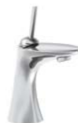
3.1155.1.004.111.1 Basin single-lever mixer, with joystick cartridge, fixed spout and pop-up waste, spout reach 105 mm Waschtischmischer, mit Joystick-Patrone, festem Auslauf und Ablaufventil, Ausladung 105 mm Mitigeur de lavabo, avec cartouche joystick, goulot fixe et vidage, saillie 105 mm Miscelatore lavabo, con cartuccia joystick, bocca di erogazione fissa e piletta, sporgenza 105 mm
